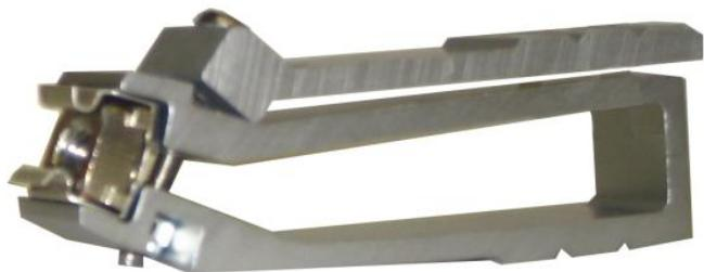
Die gebogenen Zungen der Federstahlkapsel werden mit der Mutter nach außen in das Werkzeug eingesetzt. Durch das Andrücken des Griffes wird der Käfig zusammengepresst.
